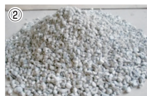
② 資源化加工後のコンクリート (RC40材)
